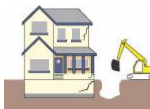
Fig. 2.2.d. Uitgravingen nabij het gebouw
