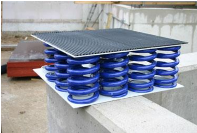
Fig. 5.2. Veren kunnen per stuk 13 kN dragen
